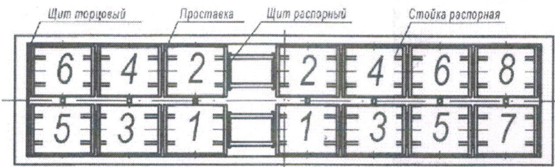
Рис.3 Последовательность разгрузки полувагона
